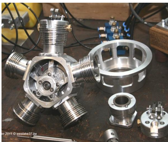
Stermotor in aanbouw
